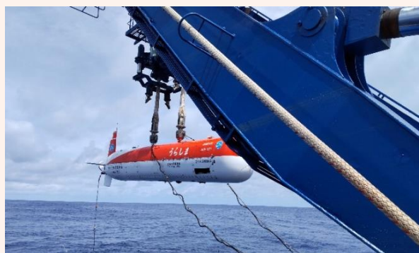
本調査航海での AUV「うらしま」投入の様子。
