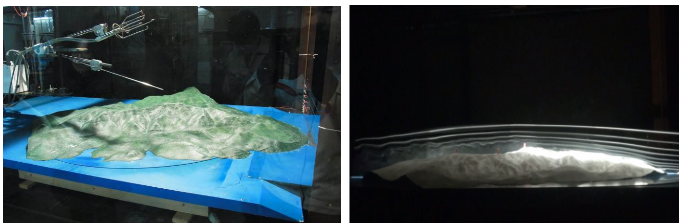
図2 九州大学における実地形模型を用いた風洞実験と風況解析検証
