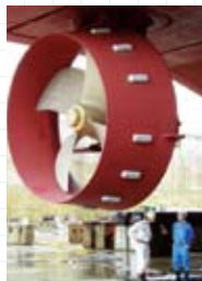
アジマススラスト 360度回転できるプロペラ 4,200kW × 6
