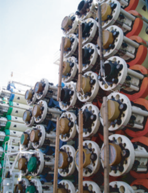
ラックに積み上げられた、浮力体付きのライザーパイプ。 地上での重量は約28トンだが水中では約4トンになる。
