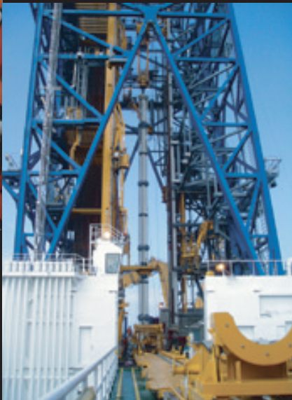
デリックの中央に立つライザーパイプ。船体中央のムーンプールから海中へと降ろされていく。
