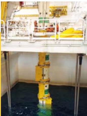
上／フェアリングを装着したライザーパイプ。写真では尻尾の方向がさまざまだが、海流を受けると一方向に揃う。右／フェアリングの取り付け作業。1個のストラップは、2本のピンだけで固定される
