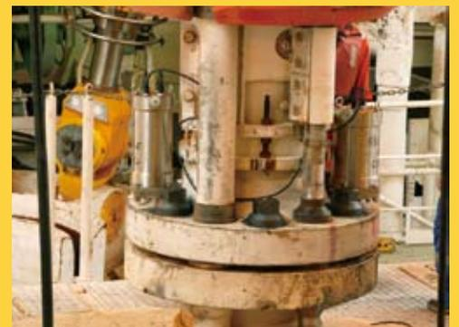
ライザーパイプに取り付けられた銀色の筒が、センサーとバッテリー。パイプの動きを記録する
