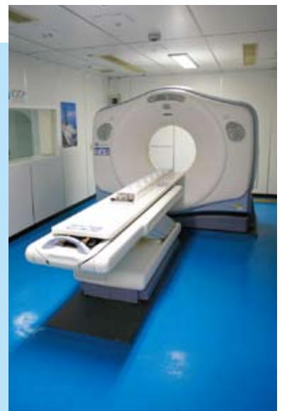
科学掘削船としては世界初の装備となる「ちぎゅう」のCTスキャナーは、医療検査用と同様の機能を持つ。ラボ・テクニシャンが行うコア分析に欠かせない
