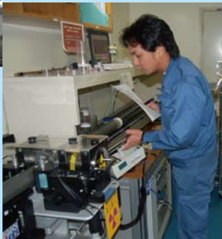
掘削されたコアを真っ先に分割したり（左上）、研究室に運び、マルチセンサーコアロガーでコアの密度や自然ガンマ線、帯磁率などを調べたり（右下）。掘削試料の対応に大忙しのラボ・テクニシャンたち
