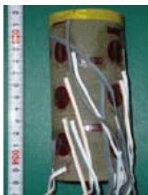
コアサンプルに歪み測定用センサーを付けて各方向の非弾性ひずみ回復（ASR）を測る（コネチカット大学・バーン博士ほかとの共同実施）
