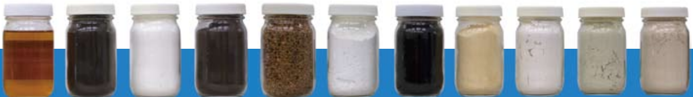
上／泥水は、船上のタンクから、ポンプの圧力で海底下に送られ、ライザーパイプの内部を通過して船上へ帰ってくる 下／さまざまな泥水材料。粘度の調整剤、比重、酸性・アルカリ性を調整する材料などがある
