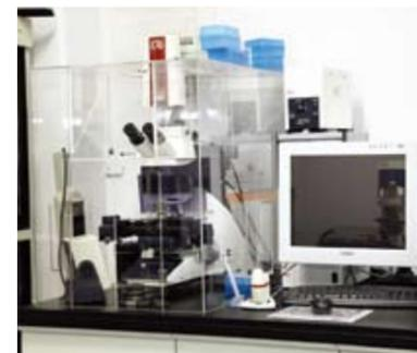
顕微鏡で観察したサンプルの微小な部分をレーザーによって切り出すことができるシステム。細胞のなかから DNA を取り出す場合などに用いられる。
