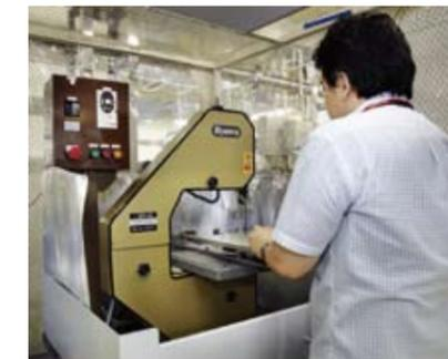
凍結したコア試料を融かさずに小さくカットするために用いられる。カッターにはダイヤモンド粒子を特殊加工した刃が使われている。
