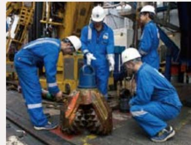
海底を掘り進むために用いられるドリルビット。作業後の確認の様子。
