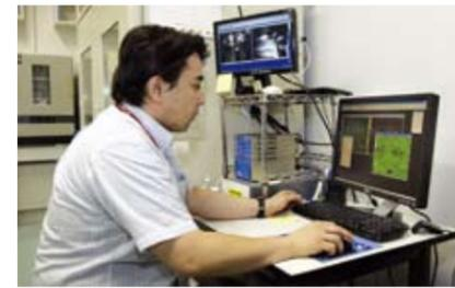
顕微鏡システムに、試料を自動的に設置するスライドローダーを組み合わせて自動的に画像を撮影。さらにコンピュータを活用し、画像からの生物由来シグナルの検出・定量化までをすべて自動化した。
