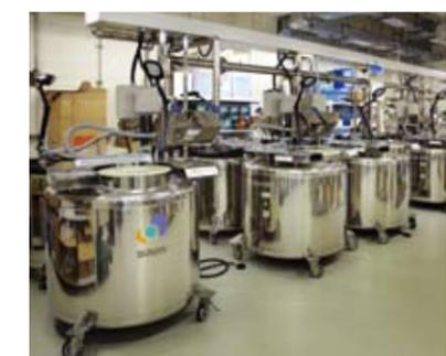
写真のタンクは、小さく切り分けたコア試料を氷点下 160℃ で長期保存する。酸素に触れることなく微生物試料を保管することができる。他に氷点下 80℃ の冷凍保管庫も設置されている。
