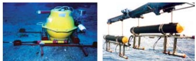
エアガン(写真右)で人工的に地震波を発生させ、その反射波や屈折波を海底地震計(写真左)などで記録し、データを解析することによって海底深部の構造を理解する調査が行われている。
