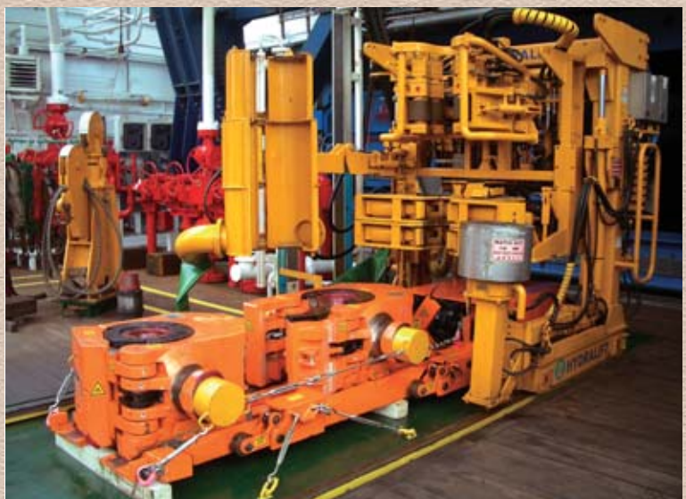
ドリルパイプ用のアイアン・ラフネック。他に口径の異なるケーシングパイプ用もある。
