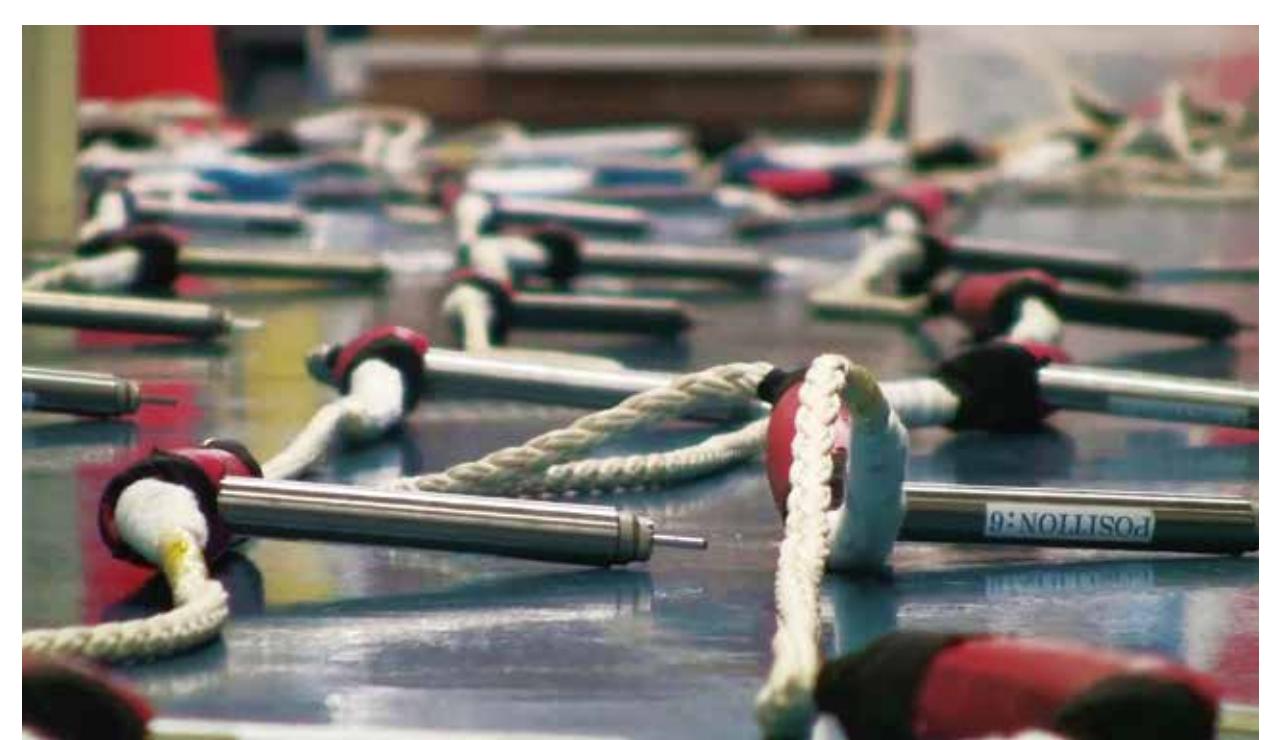
▲55 個の高精度温度計が紐でつながれ、断層周辺に集中して設置された
