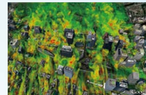
Fig.16 真夏の東京駅付近の気温分布シミュレーション。都市部の気温は郊外に比べて高くなる傾向があり、それはヒートアイランド現象と呼ばれています。(画像: JAMSTEC)
