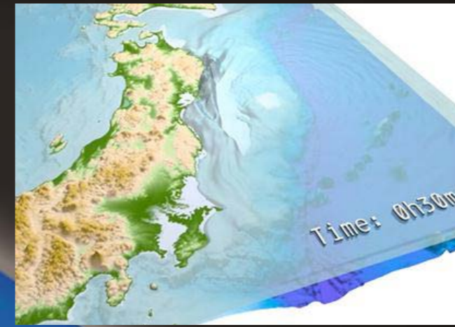
Fig.20 東海・東南海・南海地震(想定)の津波シミュレーション 海面に光を当て、また津波の高さは拡大表示しています。(画像: 東北大学大学院工学研究科 今村文彦)
