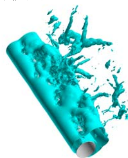
図4 非対称流れにおける後流の三次元構造 圧力の等値面図
