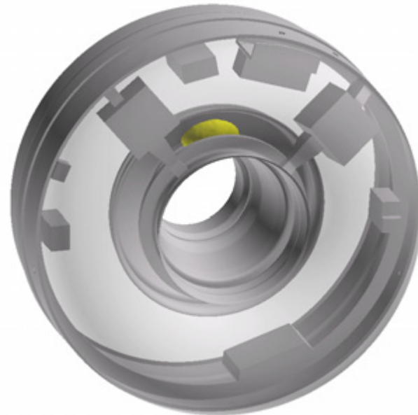
燃焼ガスの質量分率等値面(0.05) (実時間で1000msecの非定常計算)
