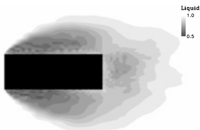
ミッドスパン平面の液体体積率分布 ( \sigma=1.0 )
