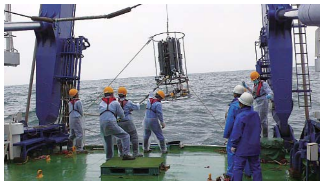
採水作業の様子 (海洋調査船「なつしま」) — RIGC 提供 —
