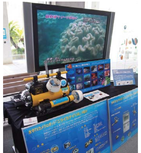
水深 150 m まで潜ることのできる、水中 TV カメラロボット「ニライカナイ 150」と撮影された映像
