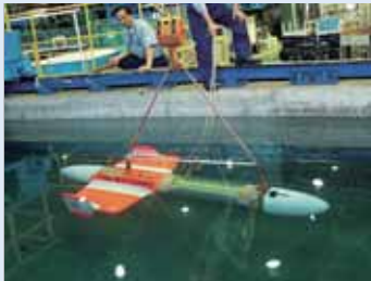
自律昇降型定域観測ロボット試験機の水槽試験の様子
