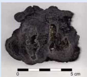
人工熱水噴出孔チムニーの断面。黒鉱床に典型的な硫化鉱物に富んでいる。
