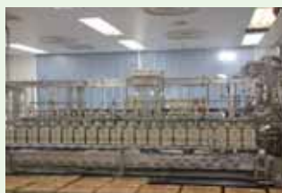
海水前処理装置。放射性炭素同位体( ^{14}\text{C} )年代測定法に用いる試料を作成するときに使用します。
