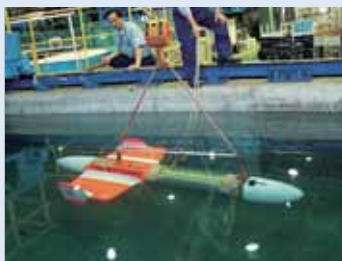
自律昇降型定域観測ロボット 試験機の水槽試験の様子
