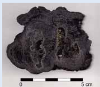
人工熱水噴出孔チムニーの断面。黒鉱床に典型的な硫化鉱物に富んでいる。
