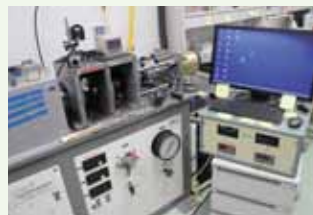
岩石の物性を計測するためのリング式高速剪断摩擦試験機
