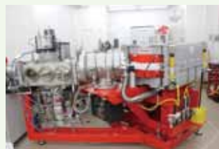
高精度大型2重収束セクター磁場質量分析計(IMS-1280HR)
