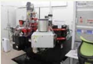
超高空間分解能二次イオン質量分析装置 (NanoSIMS 50L)
