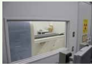
X線による透過映像を利用し、コア試料などの内部構造を非破壊で調べることのできるX線CTスキャナー
