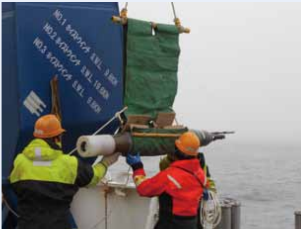
【写真左】 深海用プロファイリングフロート「Deep NINJA」投入の様子。全長は 210cm、重量は 50kg。上部（写真では右端部に相当）に水温・塩分センサーと通信アンテナがある。【図右】 「Deep NINJA」による海氷を検知し回避する（「越冬」）機能の模式図。
