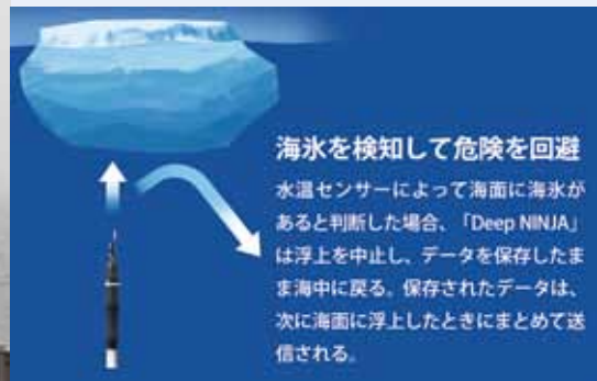
【写真左】 深海用プロファイリングフロート「Deep NINJA」投入の様子。全長は 210cm、重量は 50kg。上部（写真では右端部に相当）に水温・塩分センサーと通信アンテナがある。【図右】 「Deep NINJA」による海氷を検知し回避する（「越冬」）機能の模式図。
