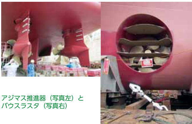
プロペラと舵による推進システム(例:海洋調査船「なつしま」)を「新青丸」の推進システムであるアジマス推進器
