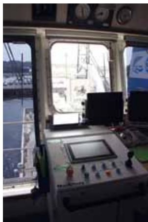
ウインチ操作室。目視やモニターなどでウインチの状況を確認しながら操作することができます。
