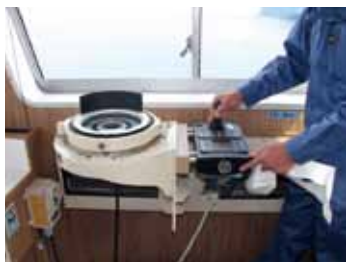
操舵室右舷側のジョイスティックレバー。このジョイスティックレバーを使って、周囲の様子を確認しながら直接操船することができます。
