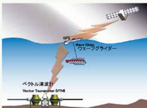
ベクトル津波計リアルタイム観測システムの構成
