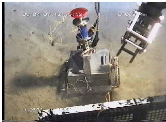
写真4 エクマン採泥器による泥の採取 (南西諸島海溝 水深 6,507m H17.4.7)
