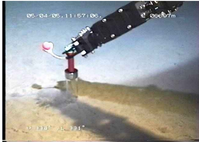
写真3 柱状採泥器による泥の採取 (南西諸島海溝 水深 7,035m H17.4.5)
