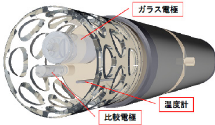
図2-2 pH-CO 2 ハイブリッドセンサのpHセンサ部拡大図。一般的に用いられている電極式のpHセンサと同様にガラス電極と比較電極の電位差からpHを測定する。付属の温度計によって測定された水温は、pHとCO 2 濃度両方の測定値計算に使用される。
