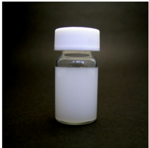
図2 (写真左) MAGIQ技術で得られた透明度の高いナノエマルジョン。透明または半透明。 (写真右) 直径数マイクロメートルの油滴からなる通常のエマルジョン。白濁している。
