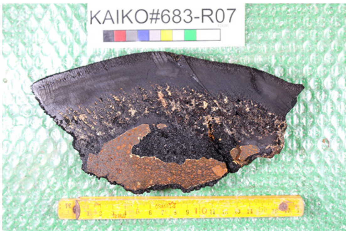
図6：水深5,500m付近で採取したコバルトリッチクラストの写真
