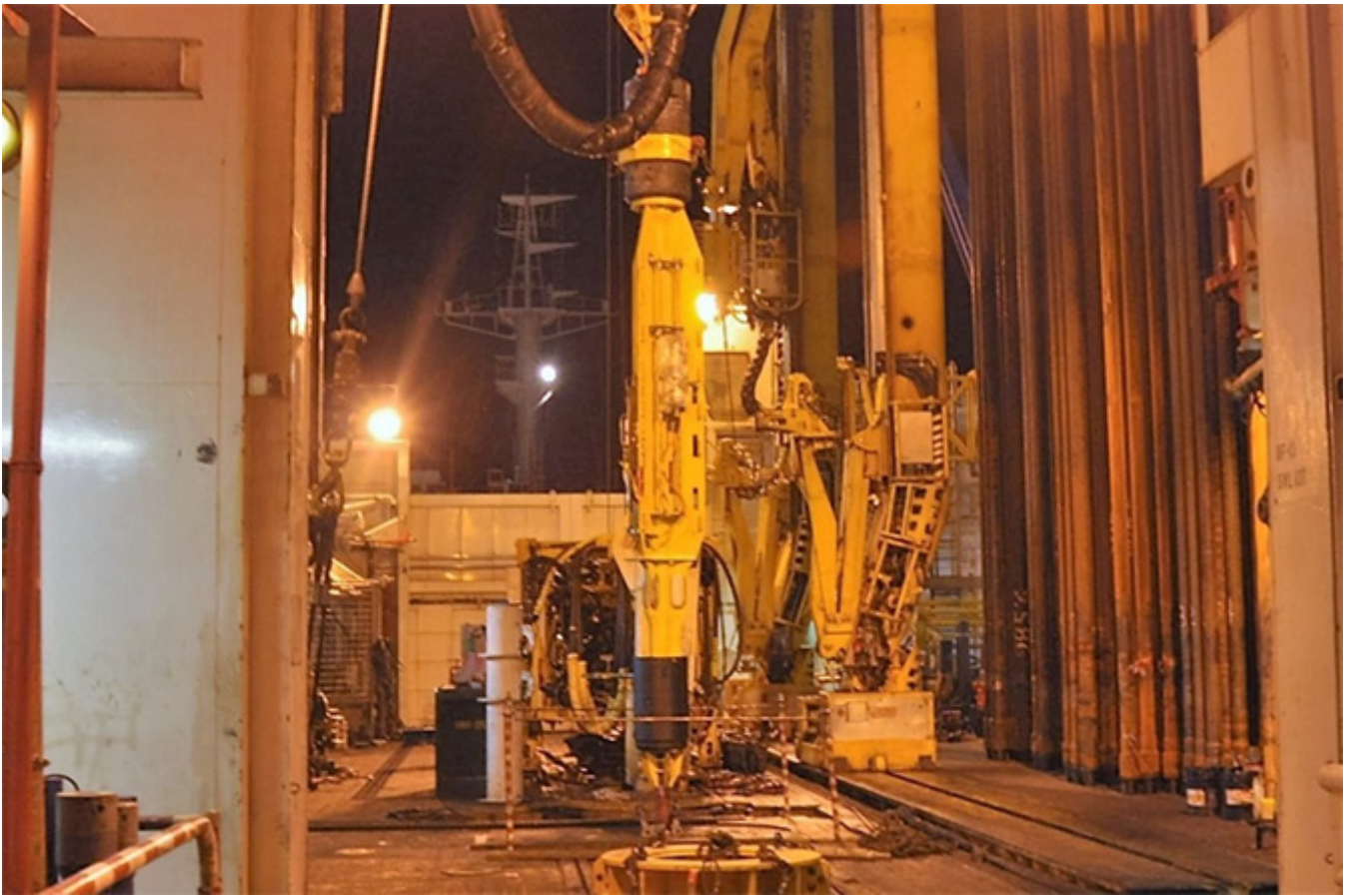
図5 孔内温度計頂部 ドリルパイプにつなげて降下、コア試料を採取した孔に設置した。
