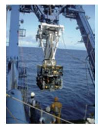
・調査船 「なつしま」 の船上から深海 へ向かう水中ロボット 「ハイパード ルフィン」、水深 3000m で作業が できる。
