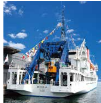
「かいこう」システムを搭載した「かいれい」の船体後部にあるクレーンを使って「かいこう」を海におろします。アルファベットの「A」の字に似ていることから、Aフレームクレーンと言います。深海の高圧に耐える「かいこう」はまさに精密機械。クレーンの操作には慎重を要します。
