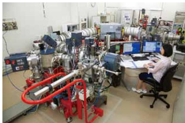
図13 高精度大型2重収束セクター磁場質量分析計 IMS-1280HR
