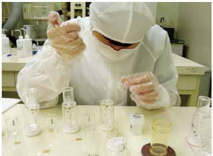
図3 クリーンルームにおける化学分離。イオン交換樹脂を用いてホウ素を分離しているところです。
