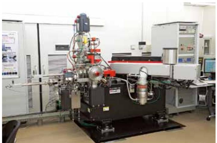
図11 超高解像度二次イオン質量分析計 NanoSIMS
