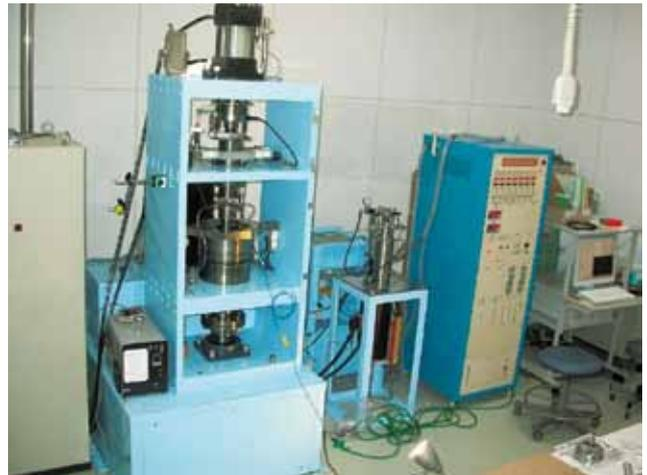
図11 断層物質の含水・圧力条件をより地下深部環境下に再現できる流体制御型中高速摩擦試験機
