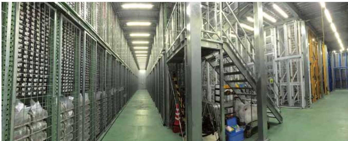
図16 2014年6月末に完成した新コア保管庫(パノラマ撮影)。コア棚は床固定式ですが、積層ラックによる中二階構造で高さ約7.5mとなり、高所作業車を用いてコアの出し入れを行います。
