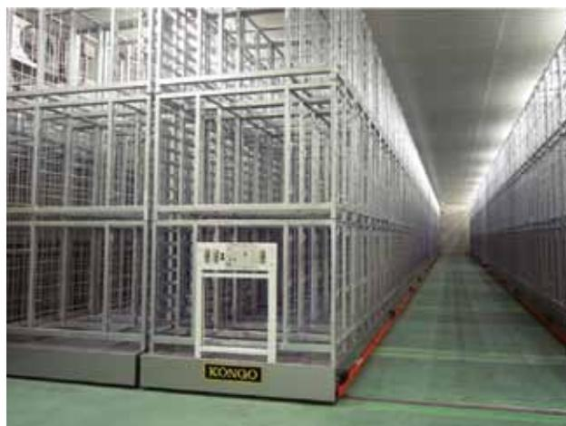
図6 レガシーコア及びIODPコアを収容するための移動式コアラックを設置(第2-4番保管庫)
