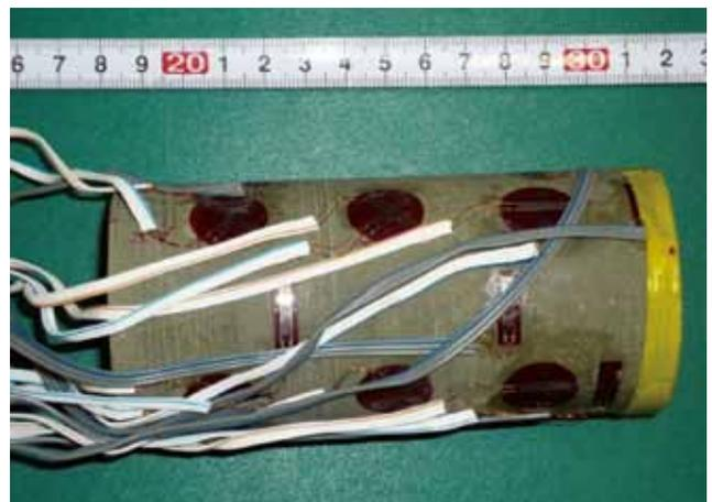
図12 非弾性ひずみ回復量測定に用いた海底下912mから採取された掘削コア試料および試料表面に貼付した測定センサー(ひずみゲージ)。
