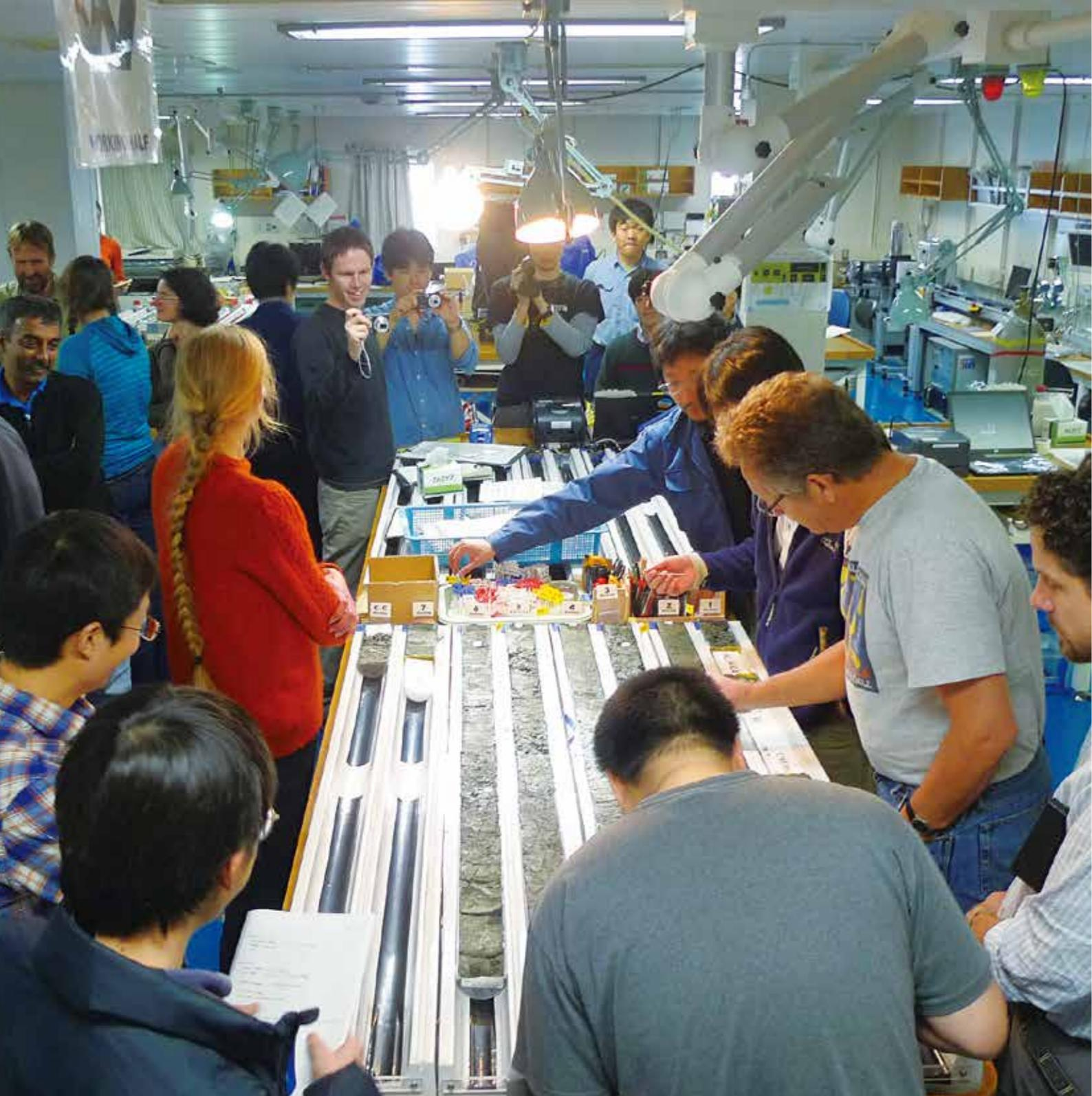
船上には大型の研究施設（ラボ）も完備され、船上で迅速かつ高精度な分析を行うことが可能。海底からのコア試料やカッティングス、試料に含まれるガスや微生物なども、すぐさまラボに運ばれ処理される。ラボでは世界中から集まった研究者たちが一丸となって、試料に刻まれた地球の謎を解いていく。
