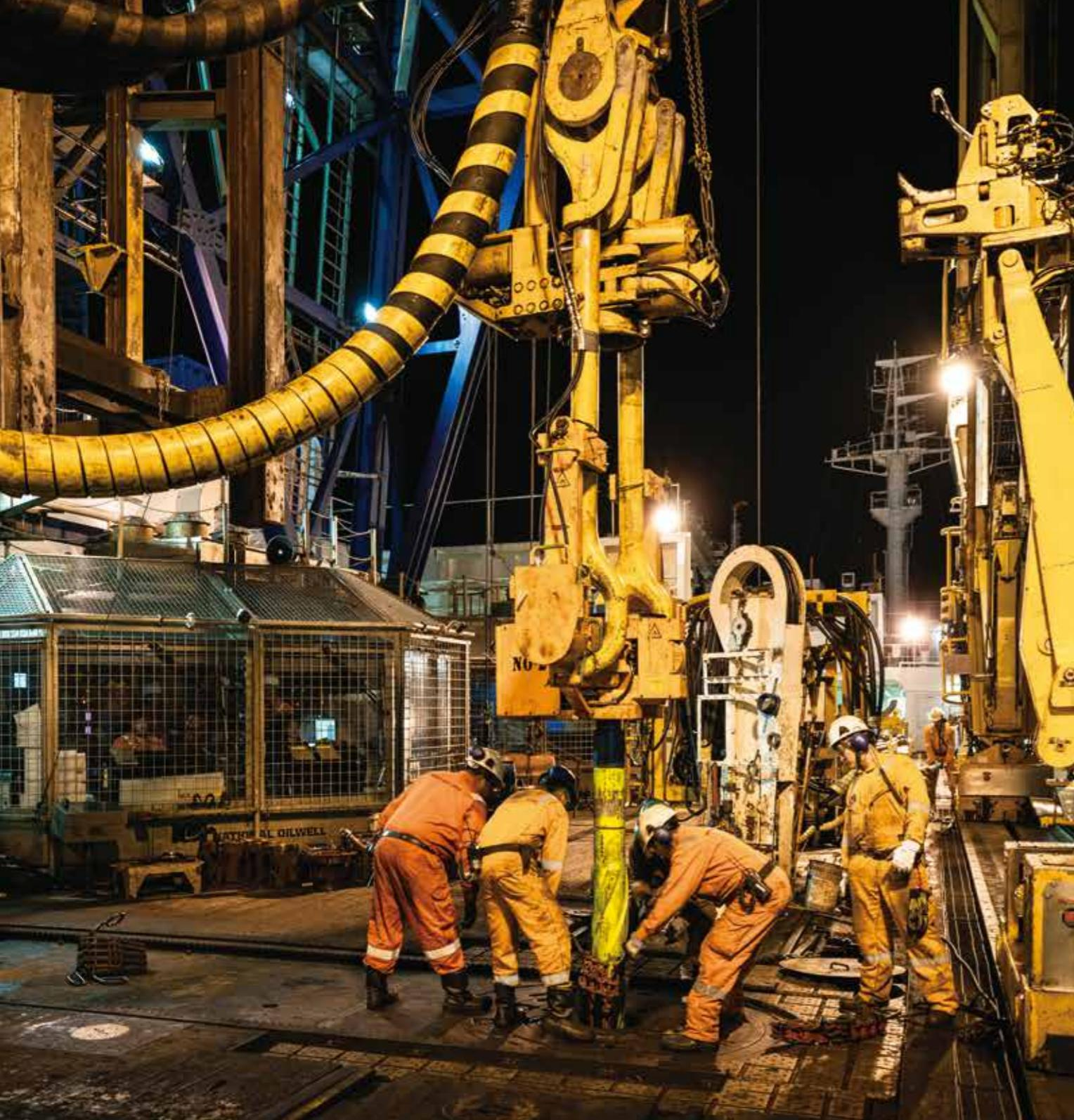
船から海底下を掘る作業場、掘削フロア（ドリルフロア）。巨大なやぐら（デリック）の下で、掘削パイプや機器を大型重機でつなぎ降下していく場所。掘削クルーは、ドーム型のドリラーズハウスで機器を操作したり、ドリルフロアで準備や組み立てを行ったり、さまざまな作業を行う。ドリルフロアは、24時間体制で昼も夜も休まず稼働する。
