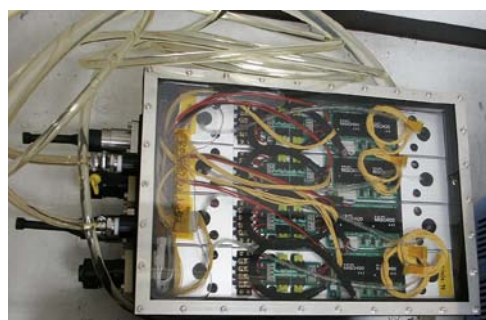
図 1 深海用リチウムイオン電池
