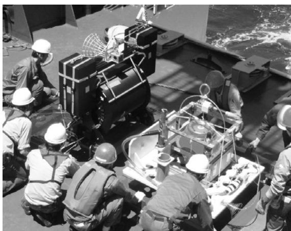
写真 左がケーブルドラム、右が観測機器本体
