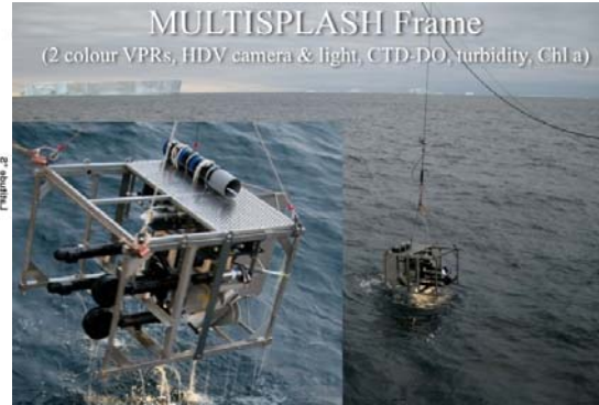
VPRを2台搭載したフレーム
