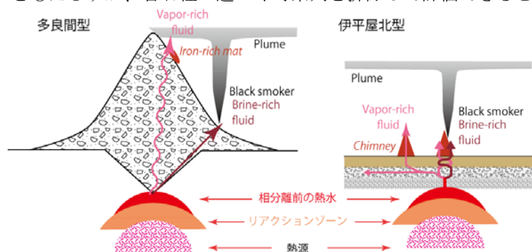
図 3 多良間海丘熱水系で期待される熱水活動モデル（左）伊平屋北（右）とは異なり山体深部で気液二層分離後あまり混合することなく海底面に達すると考えられる。
