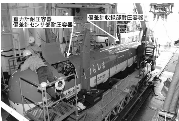
写真 移動体搭載型重力計システムを搭載した「うらしま」。前部重力計部と偏差計センサ部、後部に偏差計記録部を搭載した。
