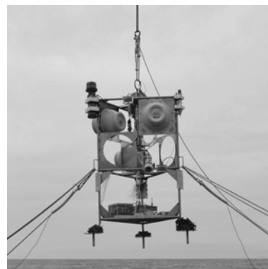
海底自動観測装置(ランダーシステム)
