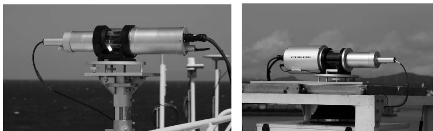
図 1. (左)「みらい」における MAX-DOAS 屋外太陽光受光ユニット (右)「かいめい」における MAX-DOAS 屋外太陽光受光ユニット
