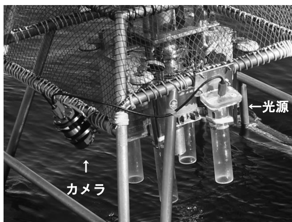
写真：マルチプルコアラーに取付けられたカメラシステム
