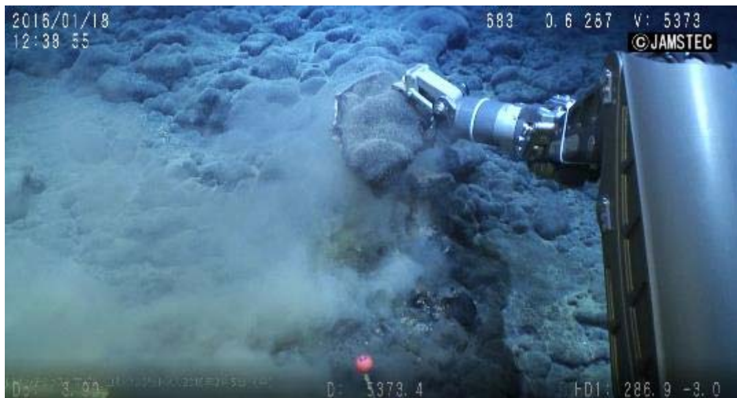
ROV「かいこうMk-IV」のアームで、拓洋第5海山の5500mの斜面からコバルトリッチクラストを採取したところ
