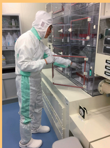
コバルトリッチクラスト試料の酸分解
