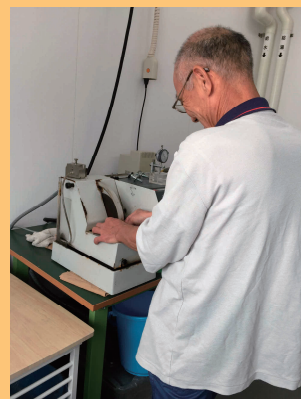
様々なカッターでコバルトリッチクラストを切断
