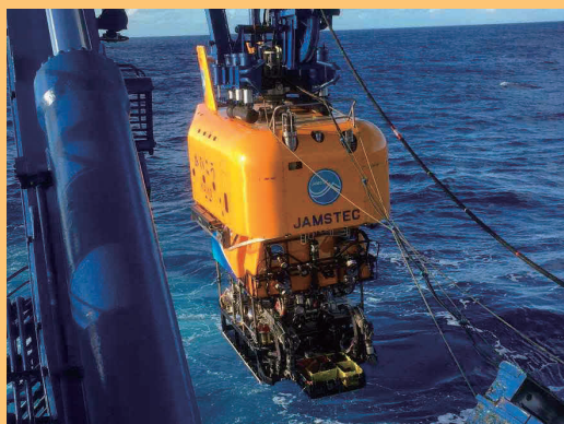
「かいこうMk-IV」が洋上に引き上げられたところ ペイロードには採取したコバルトリッチクラスト試料が乗っている
