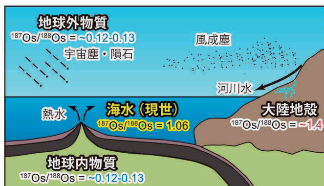
図2 現世の海洋Os同位体システムティクス。海水のOs同位体比は、3つのリザーバー（大陸、地球外物質、地球内物質）に由来するOsの供給バランスにより決定される。
