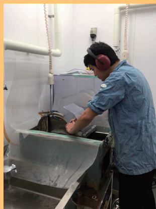
様々なカッターでコバルトリッチクラストを切断
