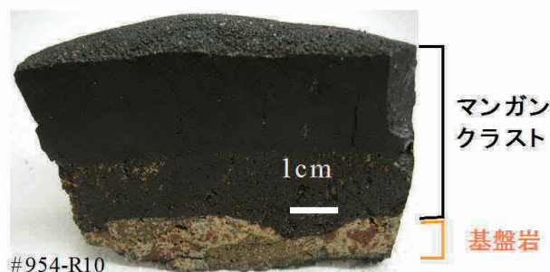
図2 拓洋第5海山のコバルトリッチクラストの断面 (Tokumaru et al., 2015)。
