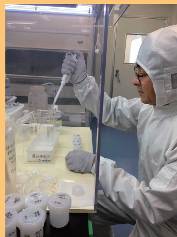
コバルトリッチクラスト試料から化学操作によってレアアースを分離
