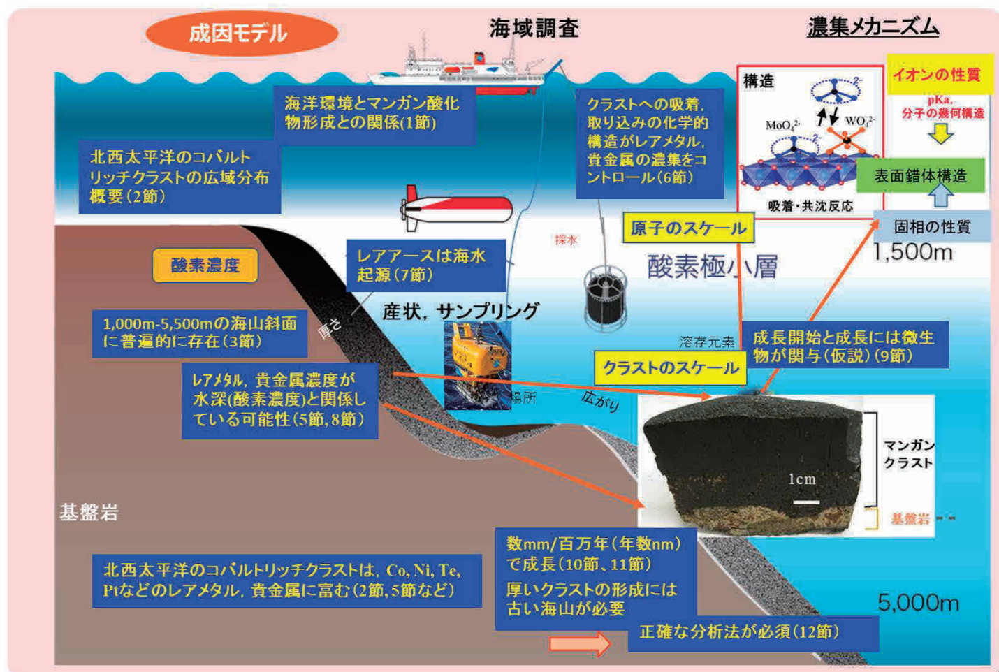
図1 拓洋第5海山における航海調査や採取試料の分析・解析によって明らかになってきた成因モデル。
