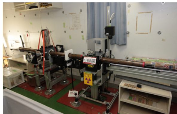
船内実験室のマルチセンサーコアロガーにより コア試料の物性計測を実施
