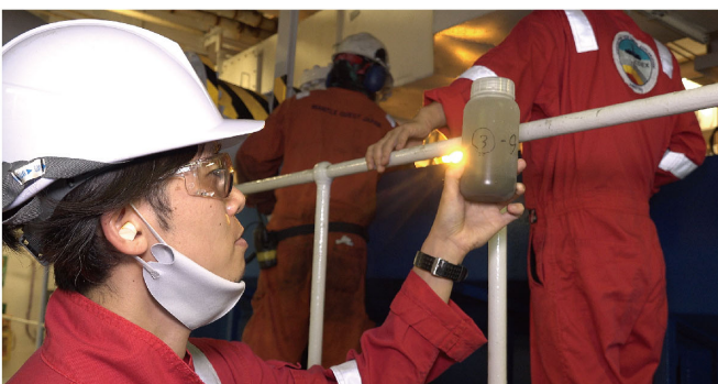
図6 海底泥スラリー試料を確認
