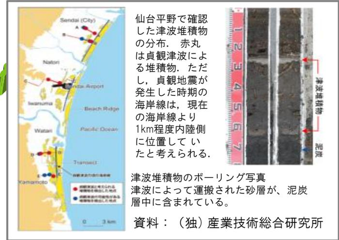
仙台平野で確認した津波堆積物の分布。赤丸は貞観津波による堆積物。ただし、貞観地震が発生した時期の海岸線は、現在の海岸線より1km程度内陸側に位置していたと考えられる。
