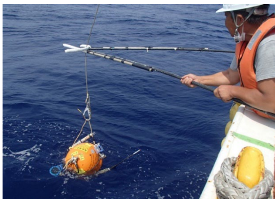
写真 2 - 2 - ③ - 5 海底地震計回収
