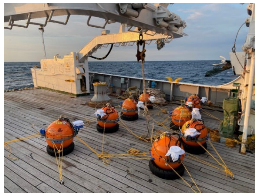
写真 2 - 2 - ③ - 6 回収された海底地震計
