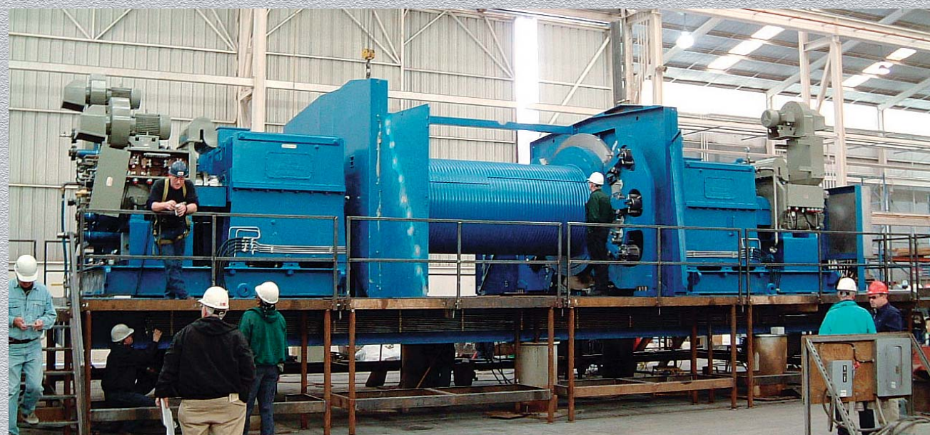
「ちきゅう」に搭載される前、米国の工場で組み立てられる世界最大のドロワークス。現在は格納されているため、その全容を見ることはできない
