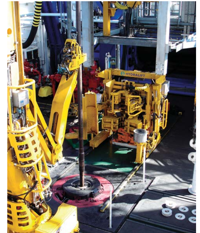
ドリルフロアの中心部。組み立てたドリルパイプをフロアの下に降下させ、フロア面のパワースリップで固定したところ。
