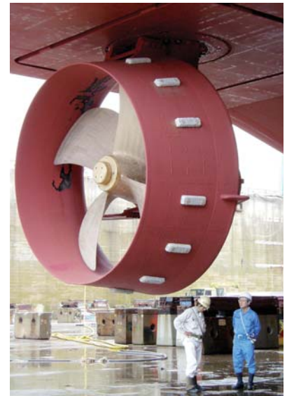
DPSでは、6基のアジマススラスト(写真)を駆動させることによって、「ちきゅう」の位置や方位を常に保つ。
