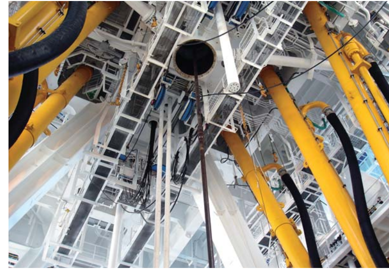
左はドリルフロアの下にあるアッパーデッキから見上げた画像。連結したドリルパイプをパワースリップ(中央の黒い丸部分)で固定しながら、徐々に下方に降下させているところ。右はドリルフロアの下方に開けられたムーンプール(12×22m)。この穴から海中にパイプを降ろしていく。
