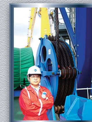
ワイヤーロープを固定するデッドラインアンカー。ここでロープ張力から吊り加重を検出する
