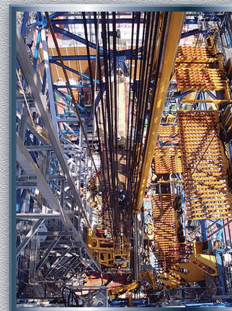
デリックトップとパワースイベルの間は各8枚の滑車でワイヤーロープを往復させ、ワイヤーロープにかかる荷重を16分の1に軽減
