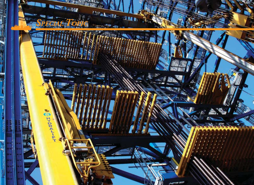
長さ9.5mのパイプを4本連結した38mのドリルパイプが、次々にデリック内部のフィンガーボードに立てかけられていく。
