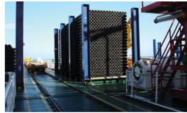
今回、パイプラックエリアには約1万m分のドリルパイプが搭載された。
