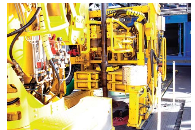
パイプ同士のネジを締めて連結したり、ゆるめて切り離したりする作業を行うアイアンラフネック(写真奥)。
