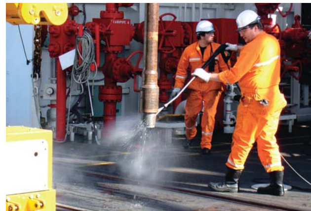
パイプの接合部分(ネジ)を洗浄するラフネック(技術者)。メイン作業は機械が行い、ラフネックは作業のサポート役だ。
