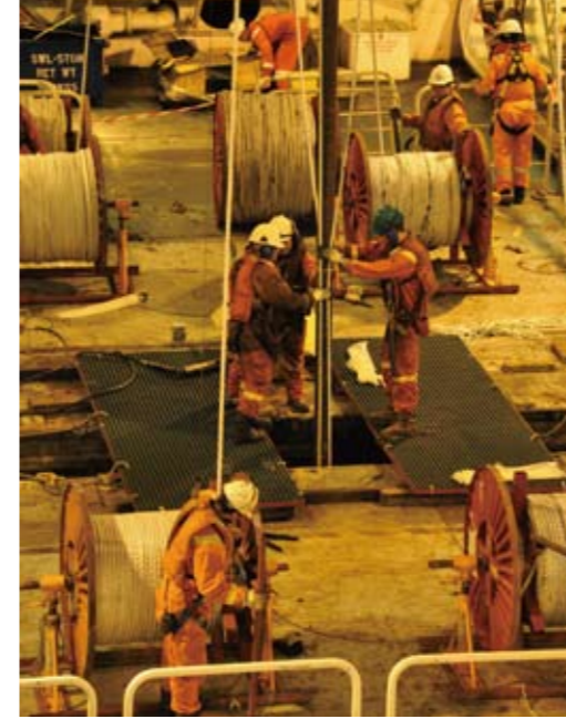
ドリルパイプに4本のロープを添わせることにより、黒潮潮流による振動を抑えることができた。
