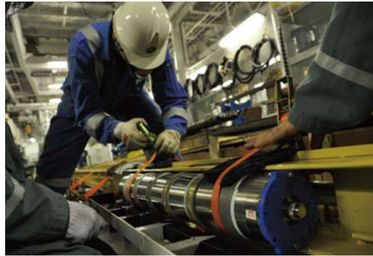
地震計や傾斜計などの観測装置をフレームに固定していく作業。
