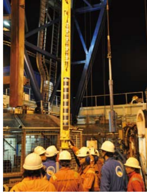
観測装置類を固定して組み上がった約7mのフレーム（手前）。
