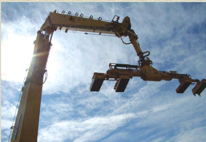
巨大なデッキクレーンの先端に装着されたマグネットヨーク。
