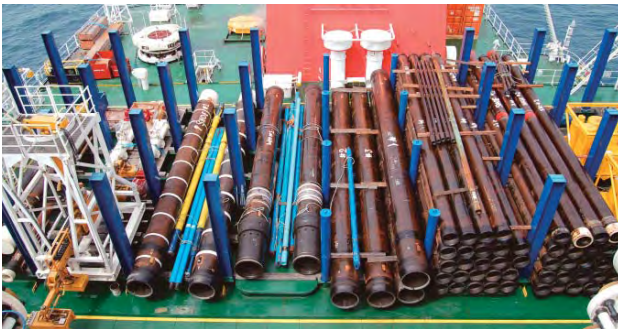
掘削孔を保護するために使われるケーシングパイプ
