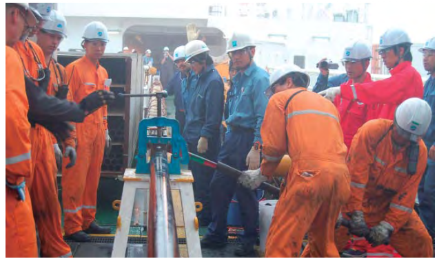
採取されたコア試料の回収作業
