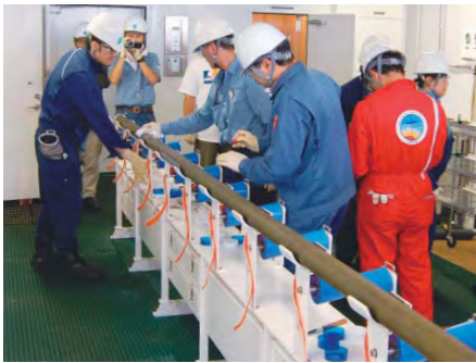
コアトランスファーベンチによって運ばれてきたコア試料を長さ1.5mに切断
