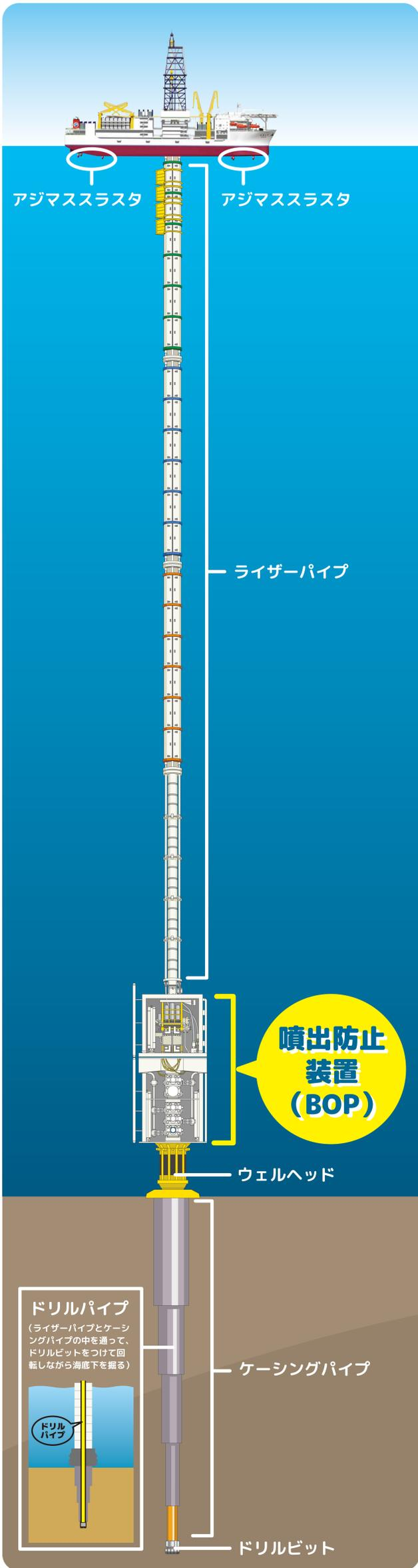
地層からの石油や高圧ガスなどの急な噴き出しを閉じ込めるために海底に設置される装置。
