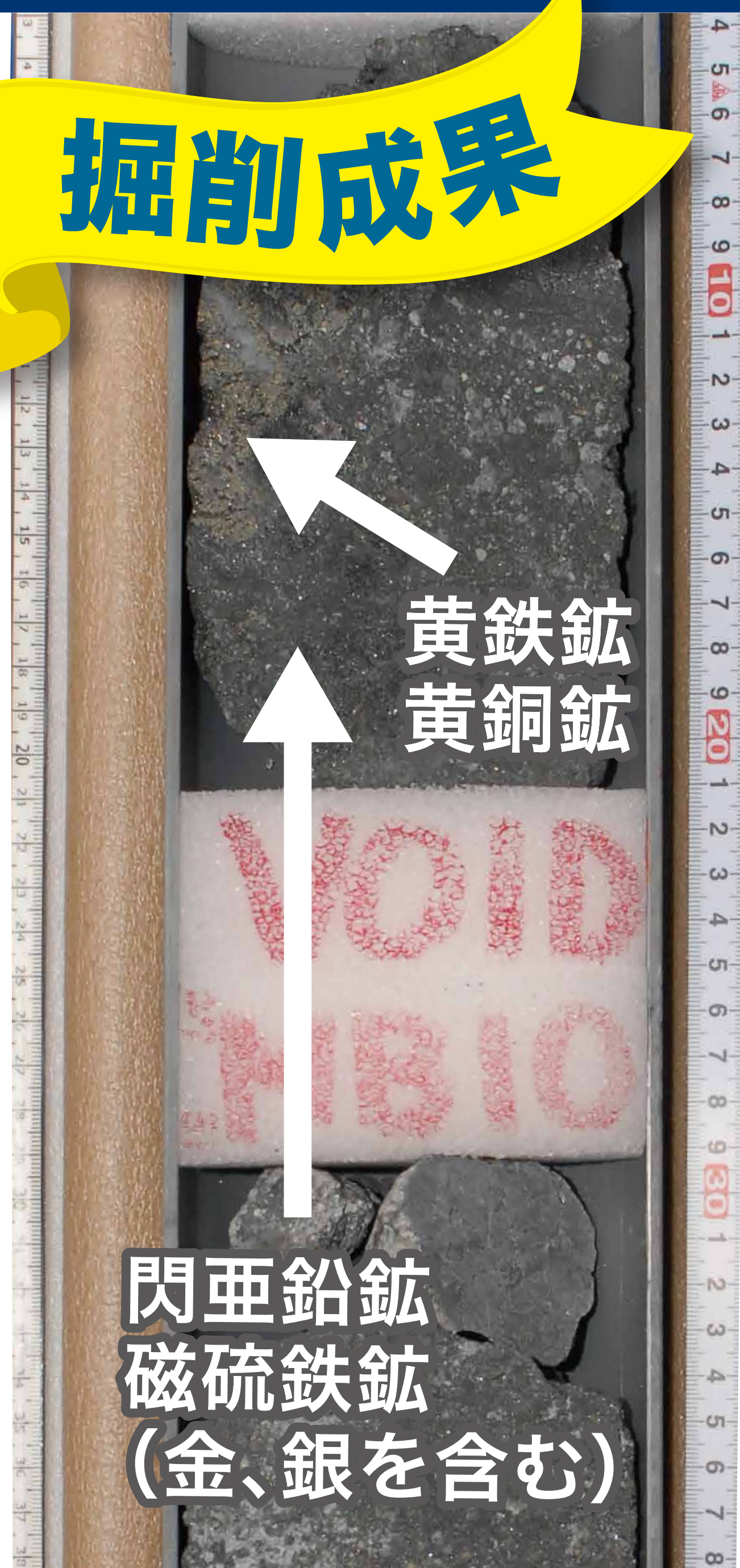
▲採取された熱水鉱床のコア試料 (水深 998m 海底下 45m)
