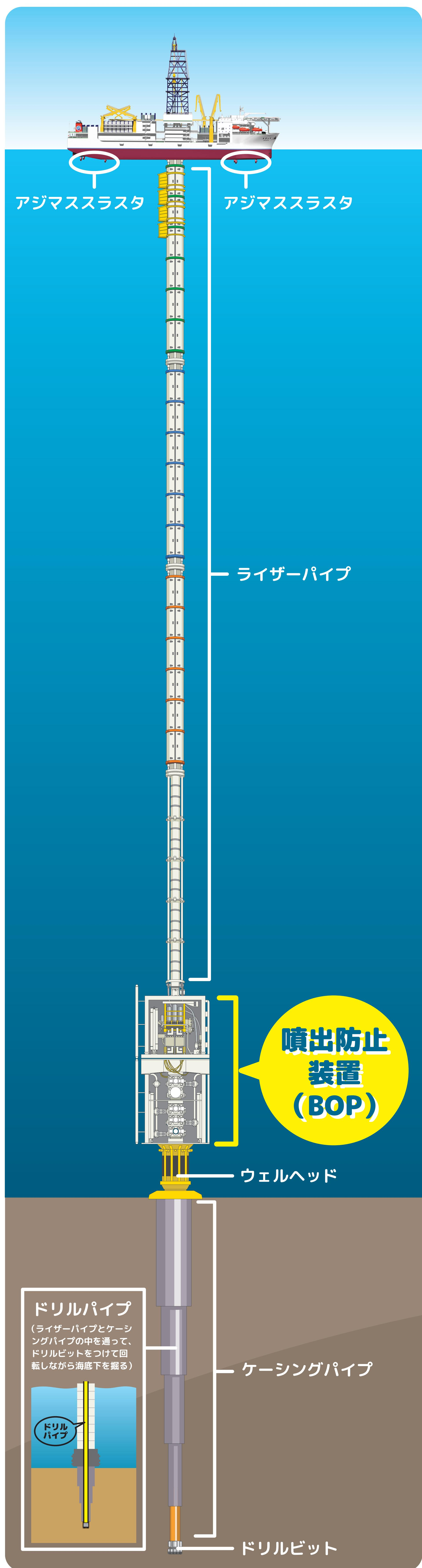
地層からの石油や高圧ガスなどの急な噴き出しを閉じ込めるために海底に設置される装置。万が一、噴出した場合は石油や高圧ガスを遮断し、ドリルパイプごと切断し、掘削孔を完全にふさぐことが可能である。
