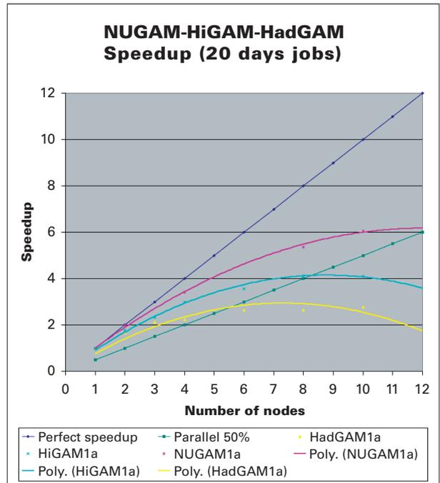
図1 地球シミュレータ上での計算性能:HadGAM (N96)、HiGAM (N144) and NUGAM (N216)、それぞれに対する結果。
