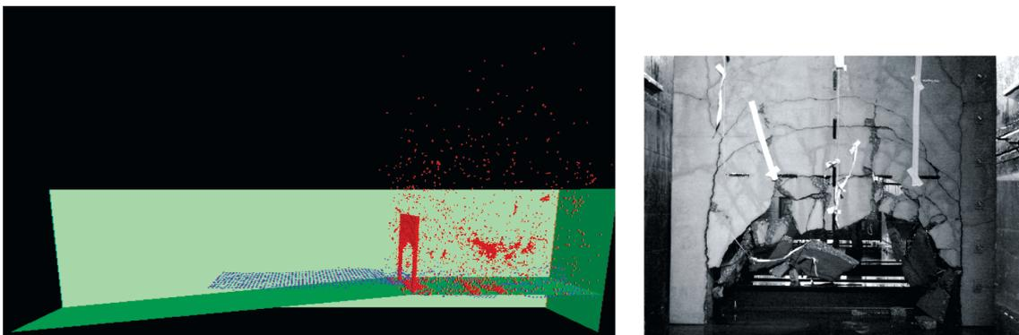
図1 壁面破壊の様子(左: STOCにより計算、右: コンクリート壁面破壊実験結果)
