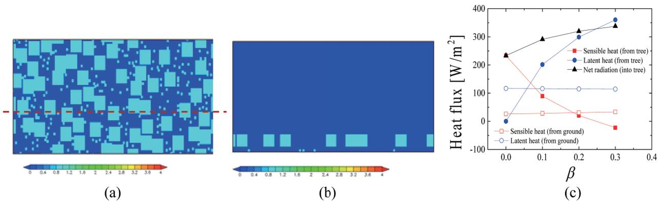
図1 高木と中低木の2種類の樹木とその配置分布を設定した理想実験の概要。(a) 高さ  $z=1.5\text{m}$  の水平配置、(b) (a) 上の赤点線  $y=29.5\text{m}$  の鉛直断面図。(c) 蒸発効率の変化による顕熱、潜熱および放射熱フラックスの変化。
